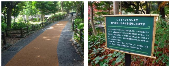
上野動物園 ジャイアントパンダの食べ残したタケを利用した園路舗装
